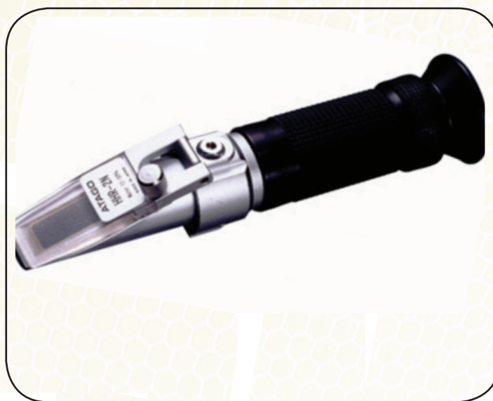
FIGURA 2. El contenido de humedad en la miel de abejas, es crítico para garantizar la calidad e inocuidad del producto, no se deberían recibir mieles con una humedad arriba de 19.5%. El contenido de humedad se mide utilizando un refractómetro.
